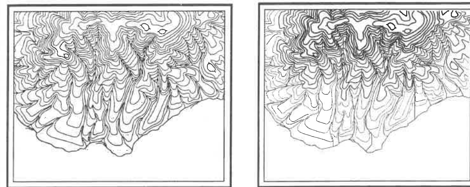
Слика 42. Приказивање рељефа изохипсама уједначених (45, 158) и прогресивно повећаних дебљина
