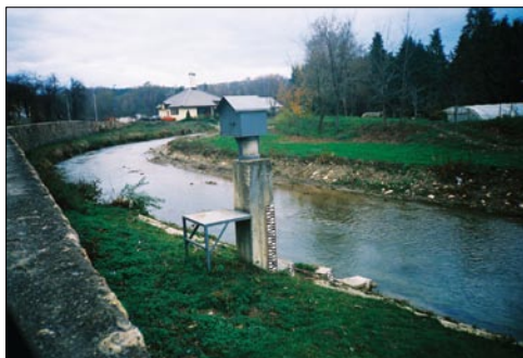
Сл. 23. Водомерна станица на реци Скрапеж у Косјерићу (фото: М. Миливојевић) Fig. 23. Hydro-measurement station on the Skrapež River in Kosjerić (photo: M. Milivojević)
